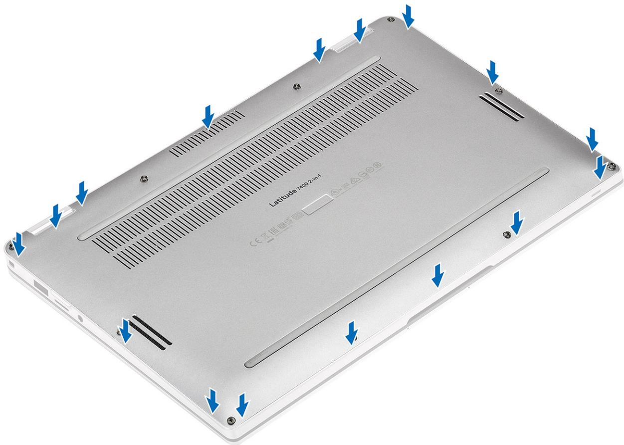
3. Ajuste los 10 tornillos cautivos para fijar la cubierta de la base a la computadora.
