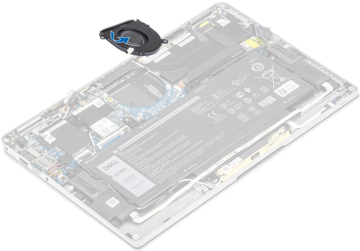
2. Reemplace el tornillo único (M2x2) [1] para fijar el ventilador a la tarjeta madre del sistema.
