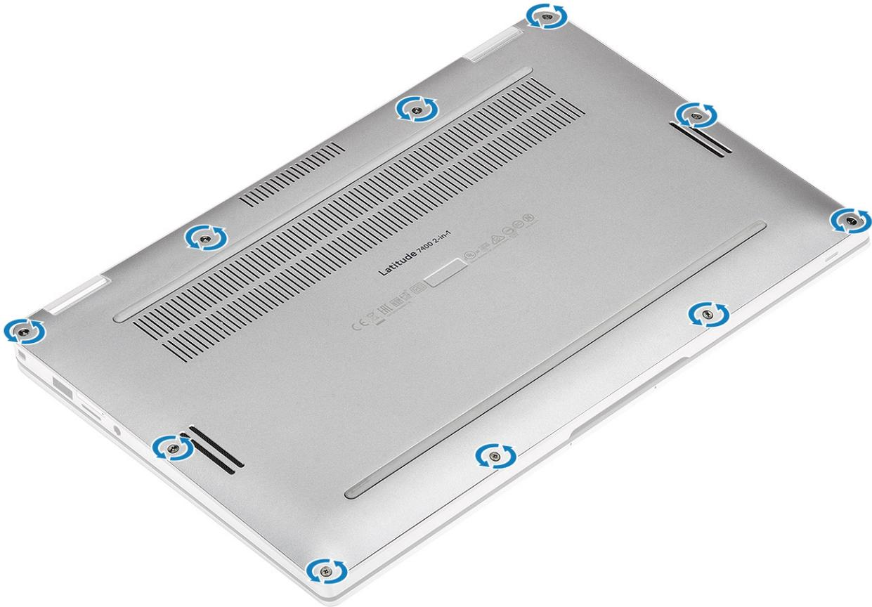
2. Utilice un instrumento de plástico acabado en punta [1] para hacer palanca en la cubierta de la base por los espacios ubicados en las muescas, como se muestra en la imagen.
