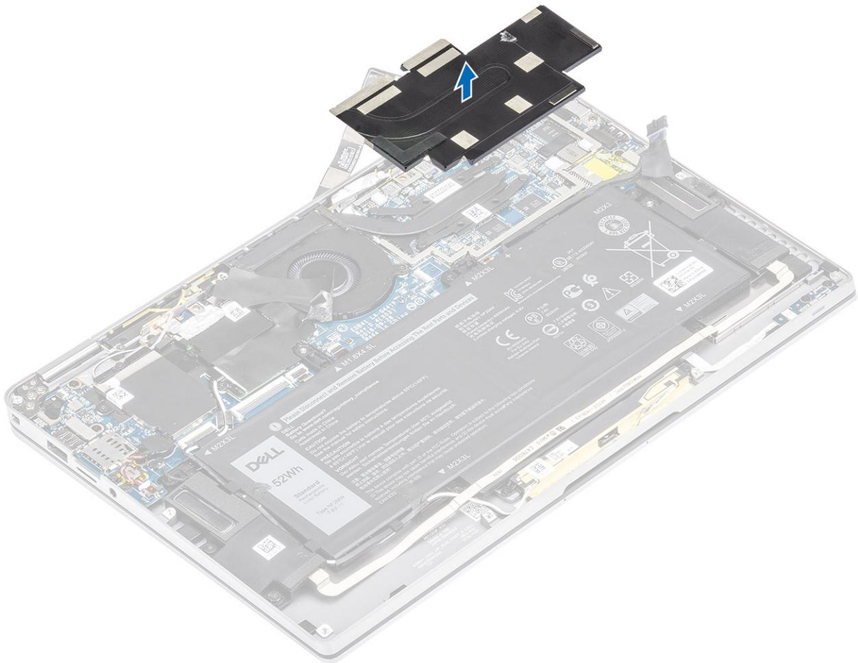
6. Quite los cuatro tornillos (M1.6x2.5) [1] que fijan el disipador de calor en la tarjeta madre del sistema.
