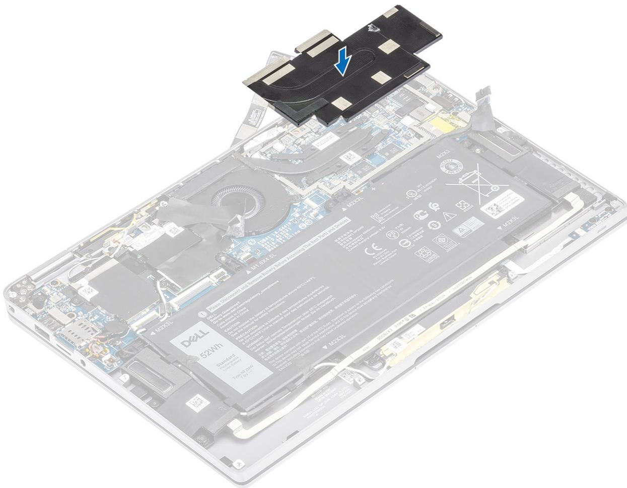
4. Adhiera las hojas metálicas en el blindaje del disipador.
