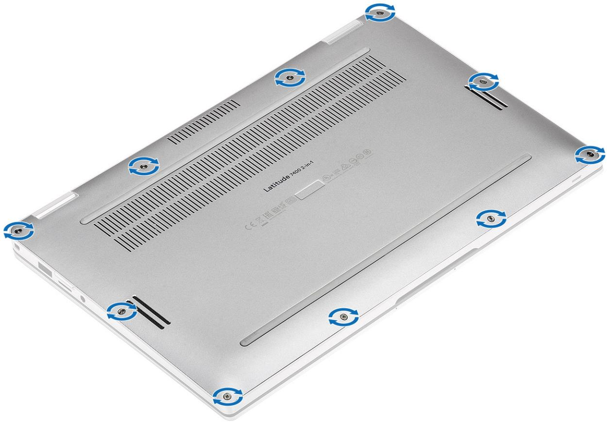
4. Presione las dos áreas centrales resaltadas del sistema, como se muestra en la imagen, después de fijar los tornillos, para completar el proceso de instalación.
