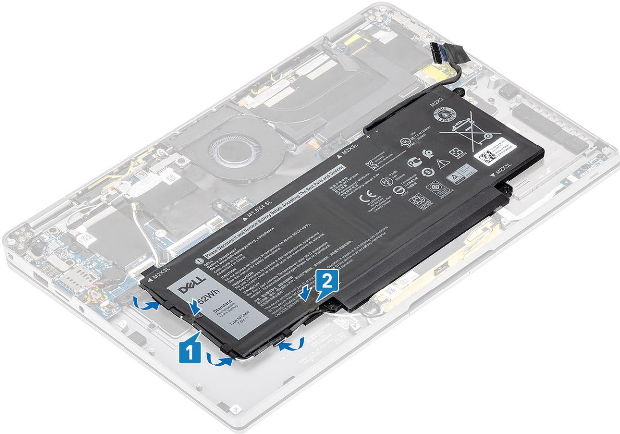
5. Conecte el cable de la batería a la placa base.
